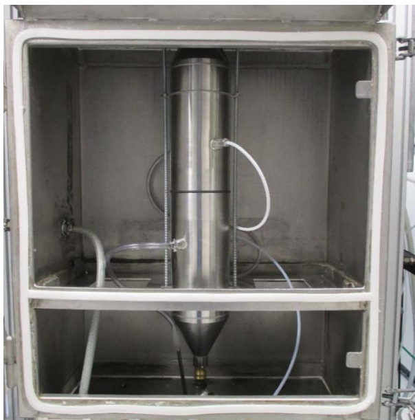
Abbildung 3: Adsorber nach DIN EN ISO 10121-1: fotografische (links) und schematische Darstellung [DIN EN ISO 10121-1:2015] (rechts)
