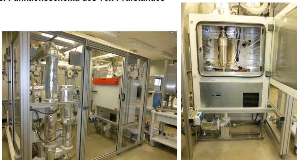
Abbildung 7: Fotos des eingehausten Prüfstandes (links) und des Filterhalters/Adsorbers (rechts)
