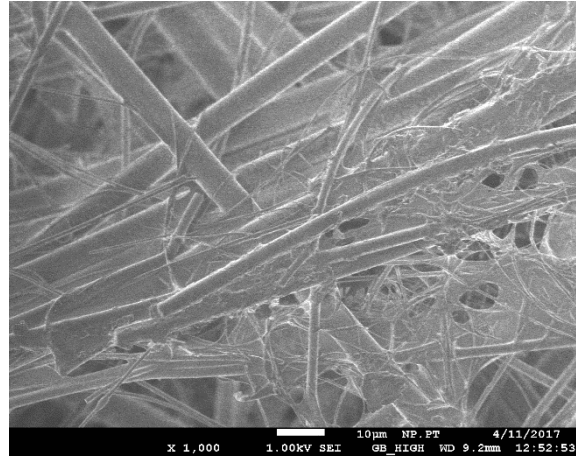
Abbildung 4.1-34: F8 Medium A – Anströmseite bei 1.000facher Vergrößerung
