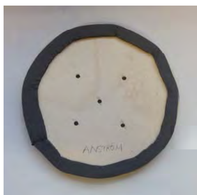
Abbildung 4.3-6: Messblende zur Überprüfung des Druckverlustes.
