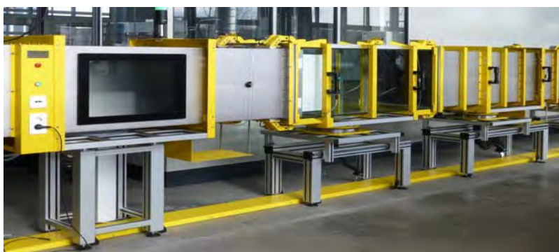
Abbildung 4.1-1: Prüfkanal nach DIN EN 779 an der Forschungsstelle 2.
