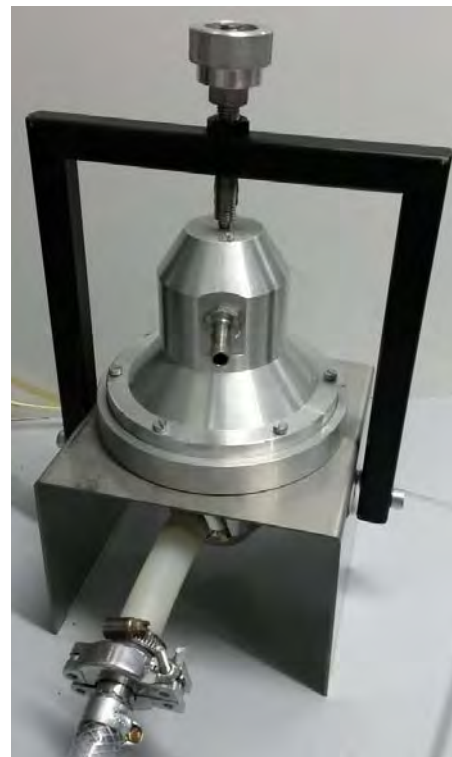
Abbildung 4.3-5: Schema nach DIN EN 1822-3 (links) und Foto der Prüffilteraufnahme (rechts).
