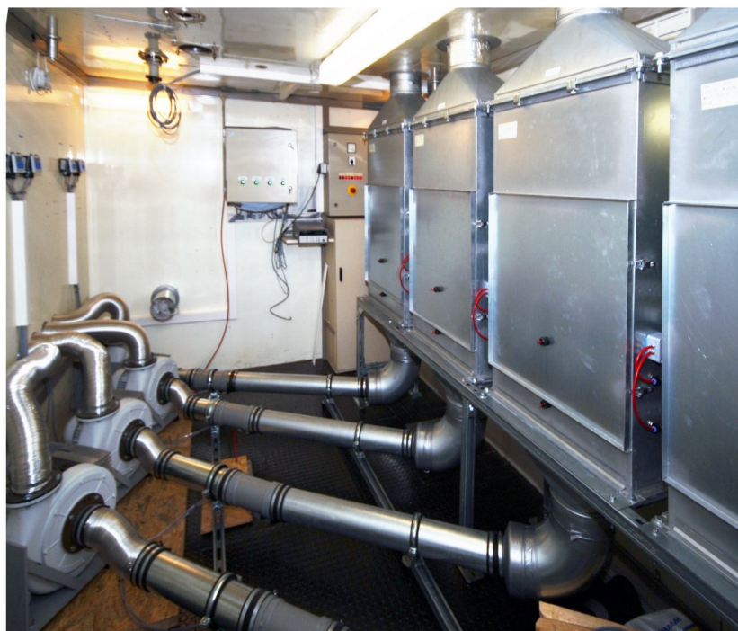
Abb. 4.4: Filterprüfkammern mit Luftführung
