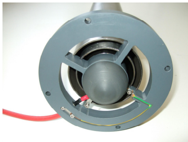
Abb. 6.3: E-Abscheider / Zwischenelektroden und Zentralelektrode mit in Flansch integrierter Nabe und elektrischer Durchkontaktierung
