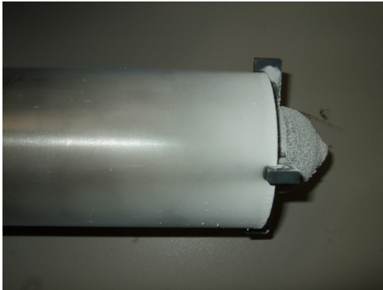
Abb. 6.14: E-Abscheider nach Verwendung von NaCl (ohne Mantelelektrode)
